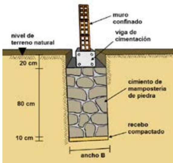
Figura 48. Dimensiones del cimiento de mampostería de piedra
