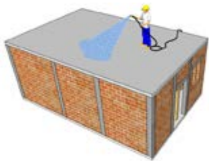
Figura 99. Curado del concreto con agua
