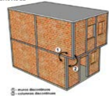
Figura 34. Discontinuidad vertical de columnas y muros
