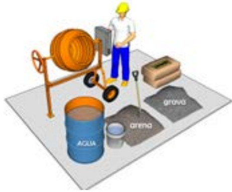
Figura 92. Materiales para el fundido de las losas de concreto
