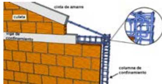
Figura 78. Anclaje de cintas de amarre a columnas
