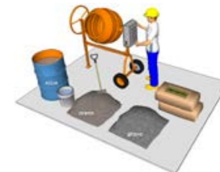
Figura 36. Mezcladora y materiales para hacer el concreto.
