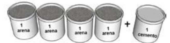
Figura 40. Mortero de pega con cemento-arena, dosificación 1:4 en volumen
