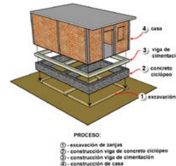
Figura 43. Proceso para construcción de la casa
