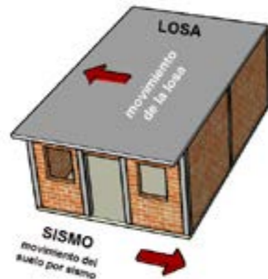
Figura 27. Casa con pocos muros en el sentido corto
