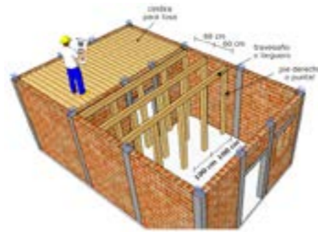
Figura 93. Largueros, puntales y formaleta de la losa
