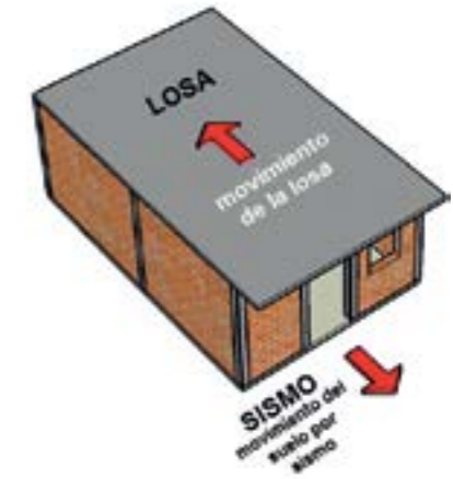
Figura 25. Desplazamiento por sismo de la estructura en el sentido largo
