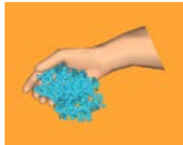
Figura 38. Se desmorona, falta agua o falta arena. Fuente: adaptada de [2].
