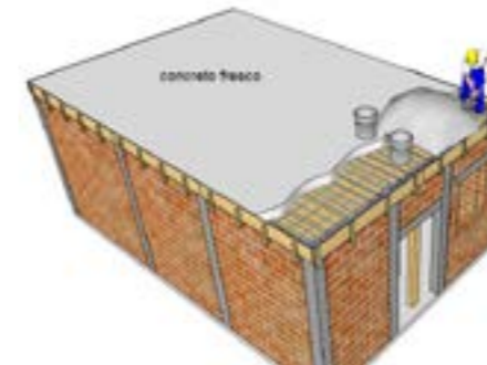
Figura 96. Largueros, puntales y formaleta de la losa y las vigas
